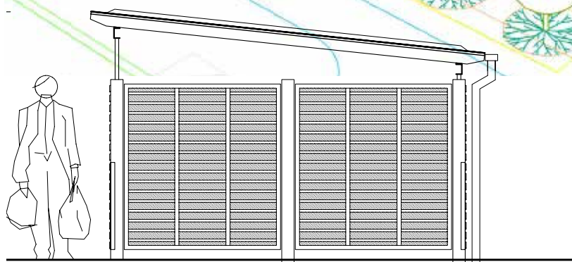
Produktionstegninger til cykel- og tørreskur til projekt for GBL. Modul opbygget så størrelse og funktioner kan tilpasses de lokale ønsker.
